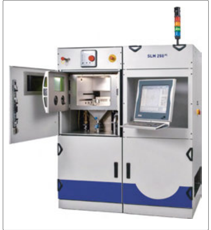
Eine der beiden im Innovationspark Biel/Bienne installierten Metall-3D-Drucker für Titan, Alu und Edelstahl
