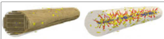
Links: Virtuelles Schnittbild (Quelle: Martin Bacher, Microtec). Rechts: Stamm mit automatisch erkannten Eigenschaften; Äste und Harzgallen (gelb), Schwarzknoten (rot), Risse (blau).
